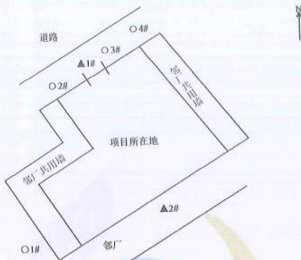
监测点位分布示意图: ○表示无组织废气监测点, ▲表示噪声监测点
