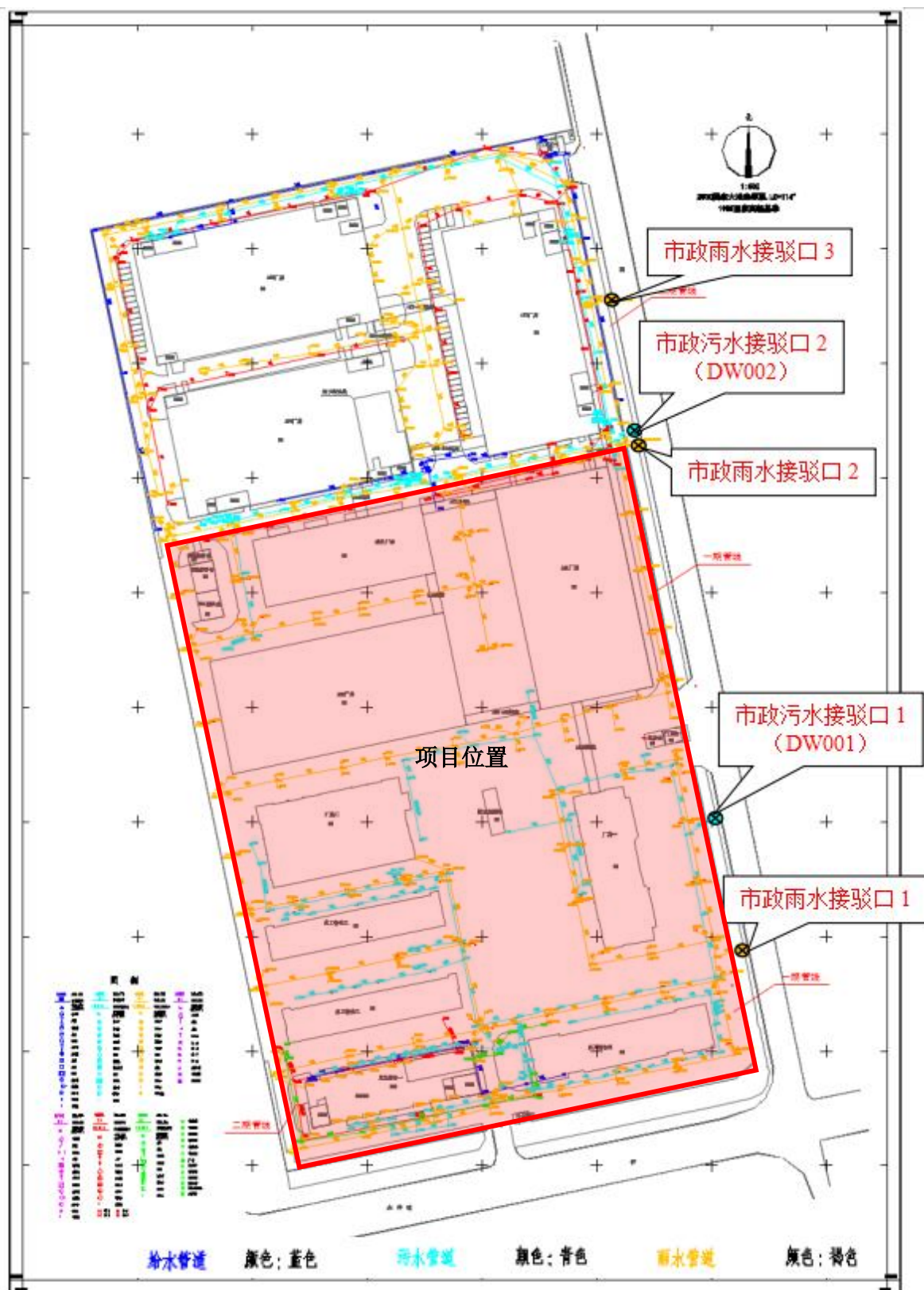
图 3-4 项目所在厂区雨污分流管网图
