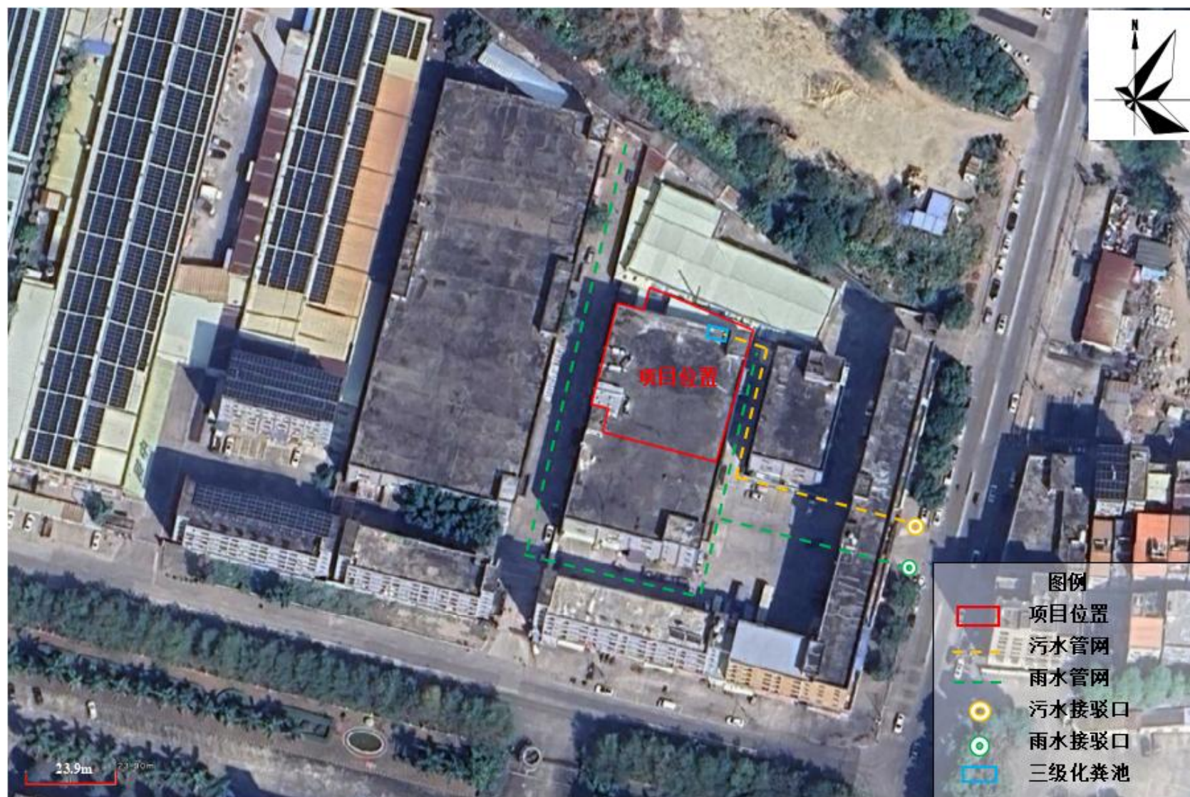
图 3-5 项目厂区雨污分流图
