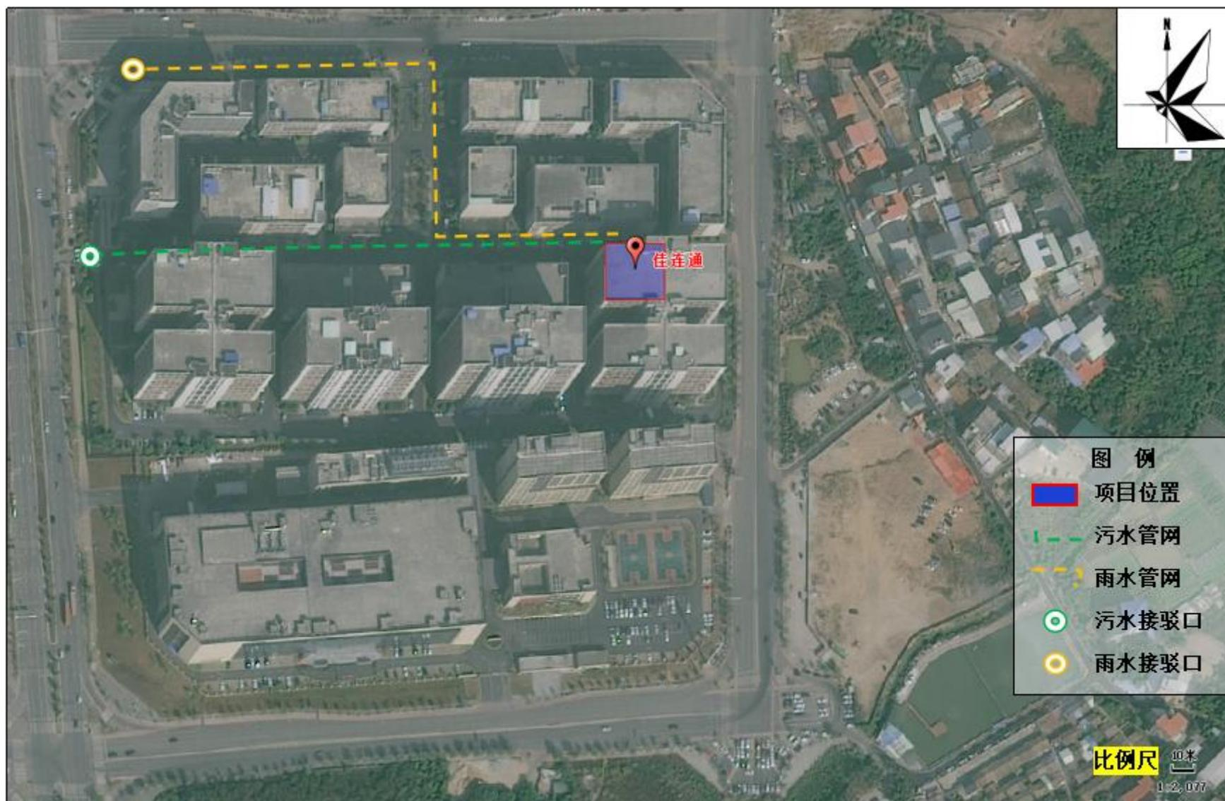
图 3-5 项目厂区雨污分流图
