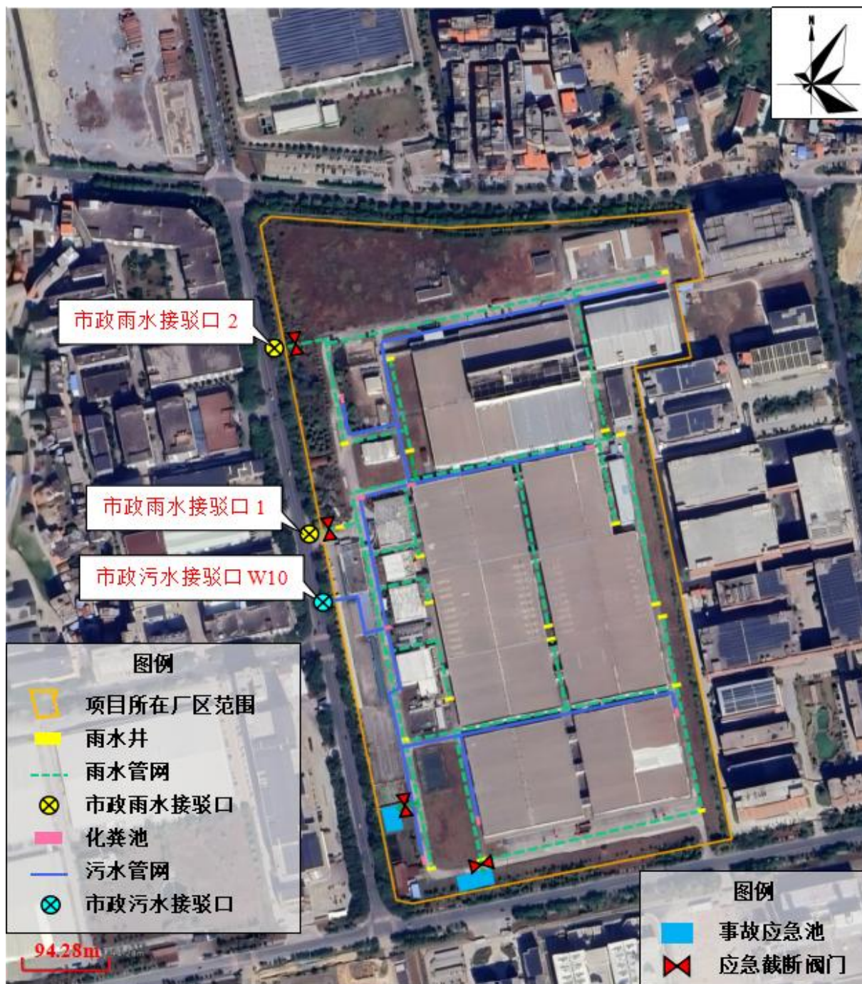
图 3-11 项目厂区雨污分流图
